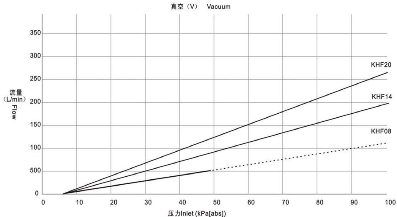
※性能实测数据表示带过滤器的数据。配管连接时由于其
