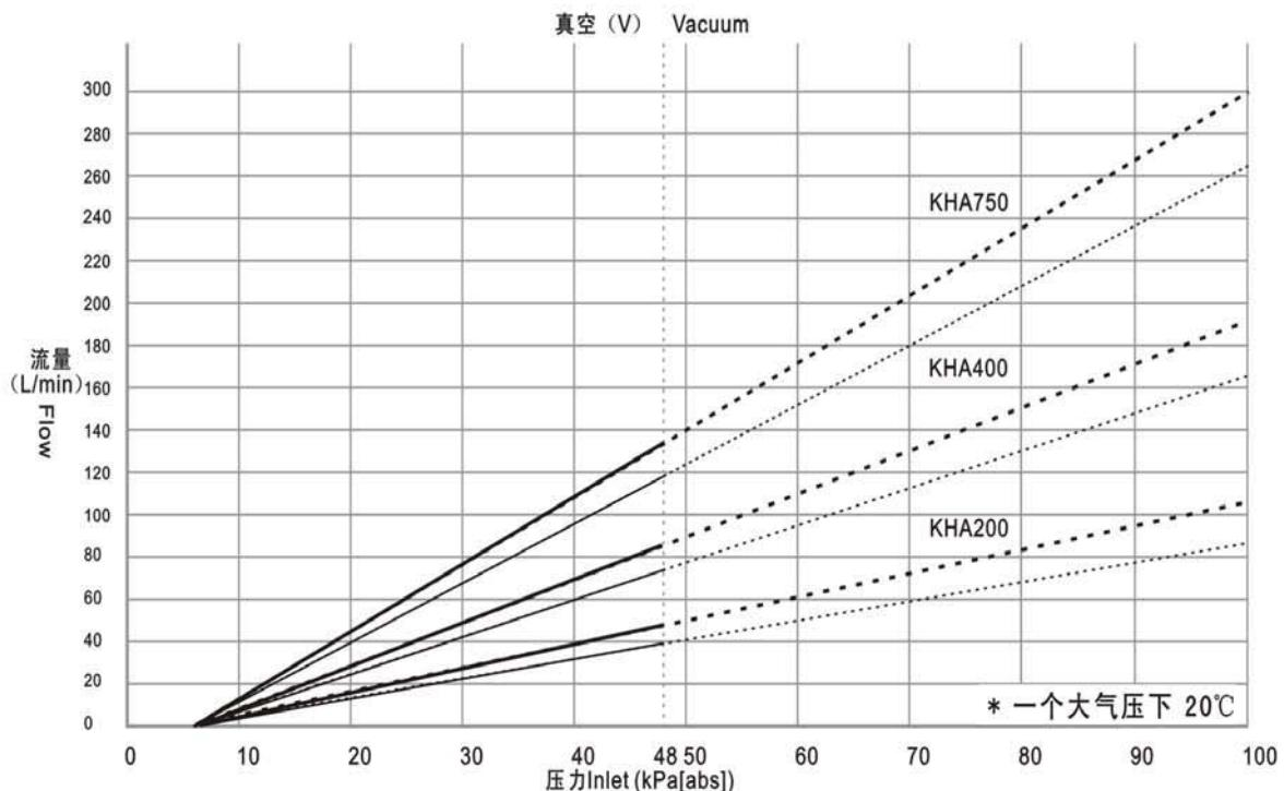
※性能实测数据表示带过滤器的数据。配管连接时，由于有阻力、流量会有所不同。
