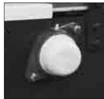
安全端盖可保护旋转的短轴
