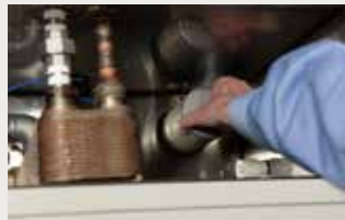
上部の水槽内部にはごみフィルタ設置。 清掃も給水も非常に簡単
