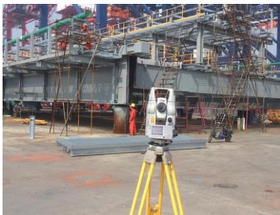
码头模块设备精度检测，其特点为精度高，尺寸大
