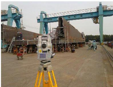
桥梁节段精度检测其特点为检控，精度高，尺寸大
