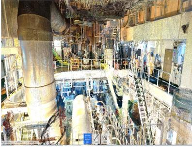
船舶修造点云扫描应用（压载水，脱硫装置等）可用于逆向设计基础。
