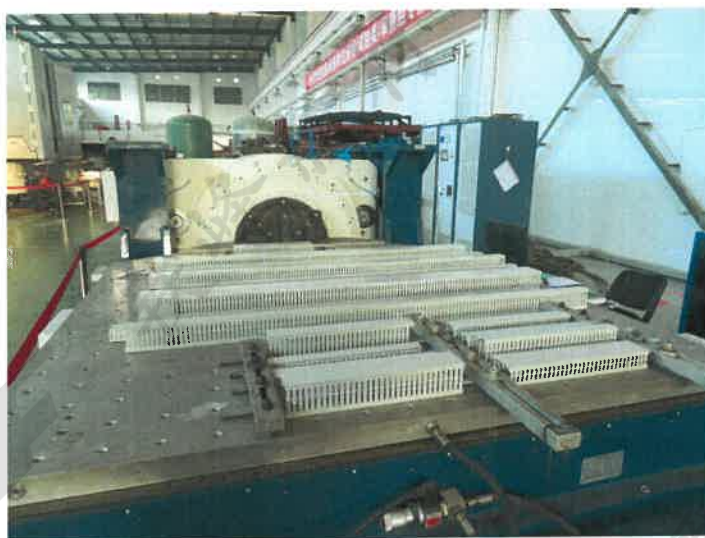
附图1 试验件横向振动试验和冲击试验安装状态
