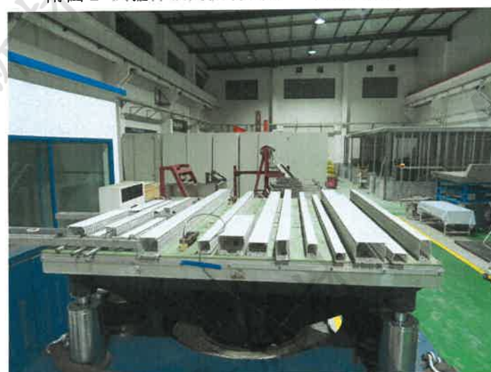
附图3 试验件垂向振动试验和冲击试验安装状态
