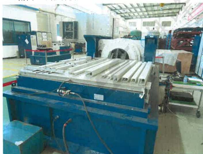
附图2 试验件纵向振动试验和冲击试验安装状态
